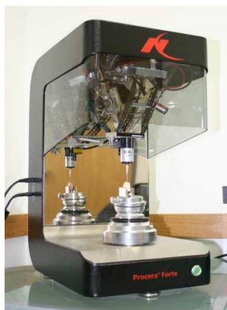
Fig.2: Contact or Mechanical scanner (Procera-forte) ([www.procera.com](http://www.procera.com))<sup>(14)</sup>
